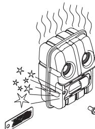
**REMARQUE!** Ne jamais utiliser la machine si le silencieux est en mauvais état.
