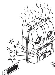
**OPOMBA!** No utilice nunca la máquina con un silenciador en mal estado.
